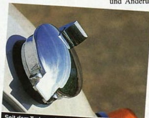
Seit dem Turboubau stark frequentiert: Hinterrm Deckel verbirgt sich ein einziger 25 Liter-Tank
