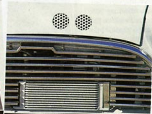
Was dem Fahrer Recht ist: Dank Ölkühler und Zusatzfrischluft fühlt sich auch der Motor wohl
