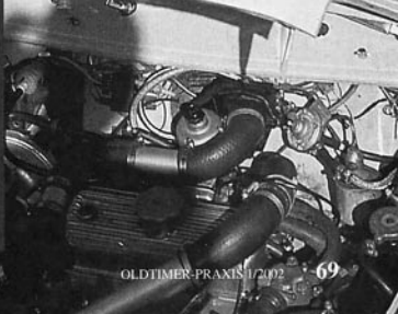
Schön zu sehen: Die verstärkte Ölpumpe am ansonsten unveränderten Motorblock
