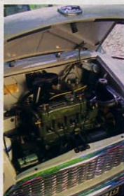
Kein Kraftpaket: der kleine Vierzylindermotor leistete nur 34 PS
